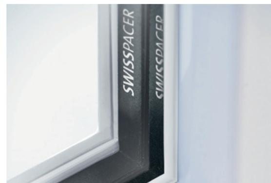
Durch den Einsatz des „Swisspacer Advance“ (warme Kante) als Abstandhalter zwischen den Scheiben reduzieren sich die Wärmeverluste und die Gefahr der Tauwasserbildung am Glasrandbereich deutlich.
