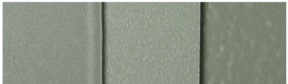
Gegenüberstellung der Strukturen: Glattstruktur, Feinstruktur und Mittelstruktur Comparison of structures: Smooth structure, fine structure and middle structure
