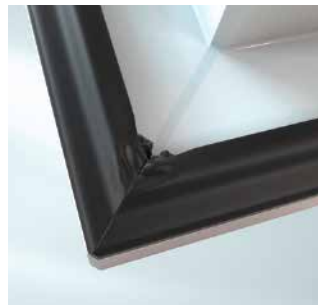
Herkömmliche Dichtungstechnologie bildet beim Verschweißen harte Ecken. Das führt zum Verlust der Elastizität und bedeutet damit verminderte Dichtigkeit.
